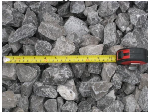
Nordegg Rail Ballast
